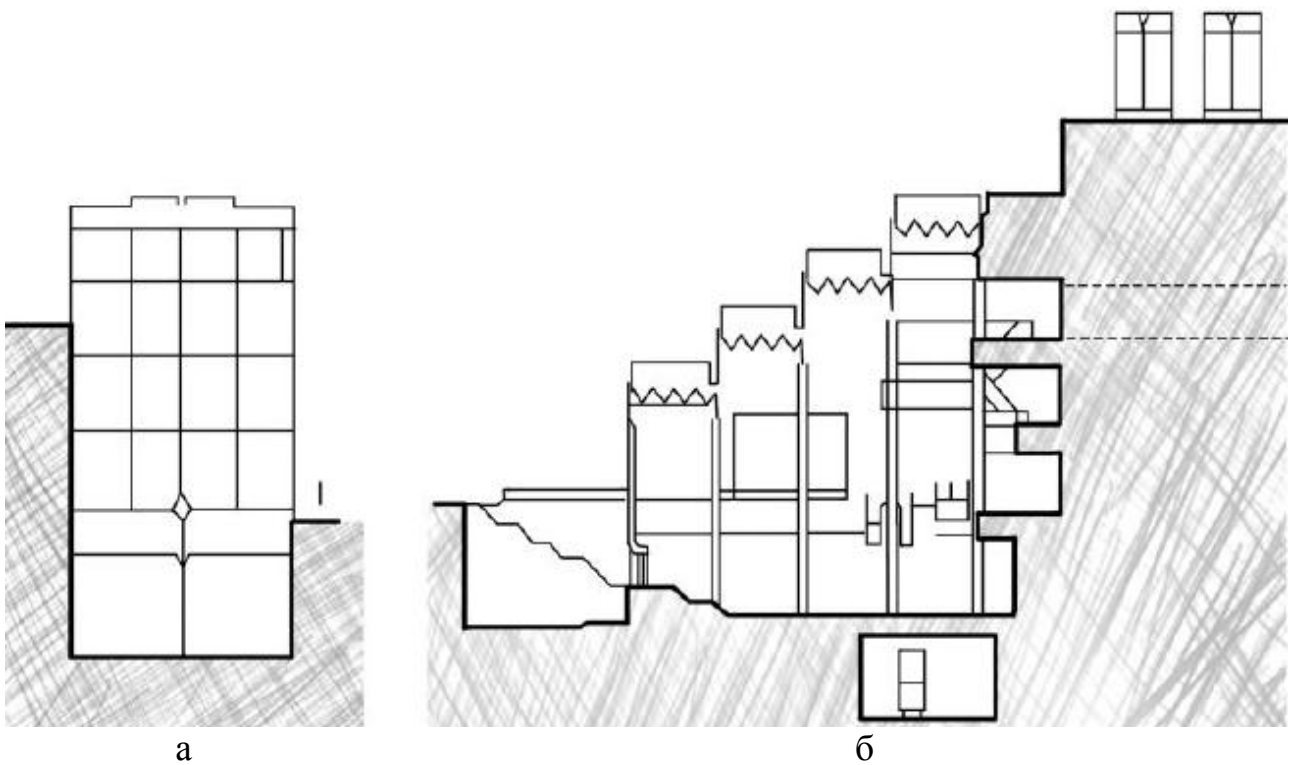
Рисунок 6 – Розрізи комплексів: а – Мілтон-Кейс центр, б – Галерея у Східній частині Маркет-стріт (м. Філадельфія)
