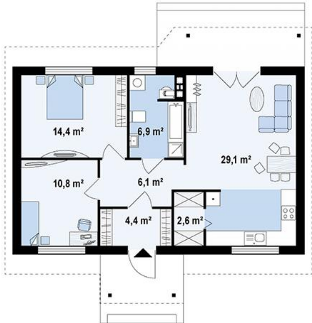
Рисунок 3 – Приклад планувального рішення одноповерхового житлового будинку Приміщення: вітальня з кухнею та їдальнею – 29,1 м 2 ; спальня – 14,4 м 2 ; спальня – 10,8 м 2 ; санвузол – 6,9 м 2 ; передпокій – 6,1 м 2 ; тамбур – 4,4 м 2 ; комора – 2,6 м 2 .
