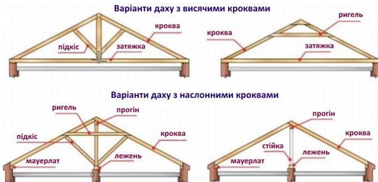
Рисунок 8 – Приклади вирішення конструкції крокв схилого даху
